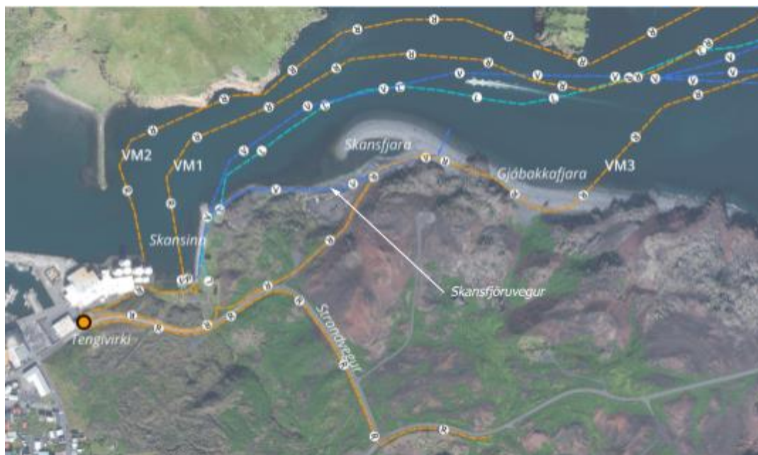
Mynd 2.1: Núverandi strengir og lagnir á skipulagssvæðinu. Appelsínugular línur (R) eru háspennustrengir, ljósblá (L) er ljósleiðari og blá (V) er vatnslögn.
