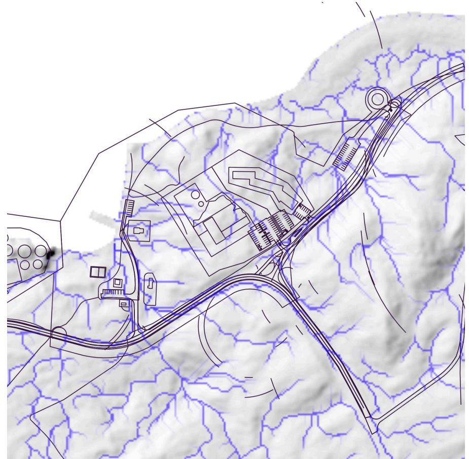
Mynd 4.3: Grunnur fyrir gerð landslagsramma sem sýnir mögulegar rennslisleiðir ofanvatns frá lóð 1 fyrir baðlón og hótél niður á láglendið neðan Skanshöfðans. Skilgreina þarf meginofanvatnsrásir niður hlíðina, við landslagshönnun lóðar 1 sem koma þarf fram m.a. á lóðarblöðum.
