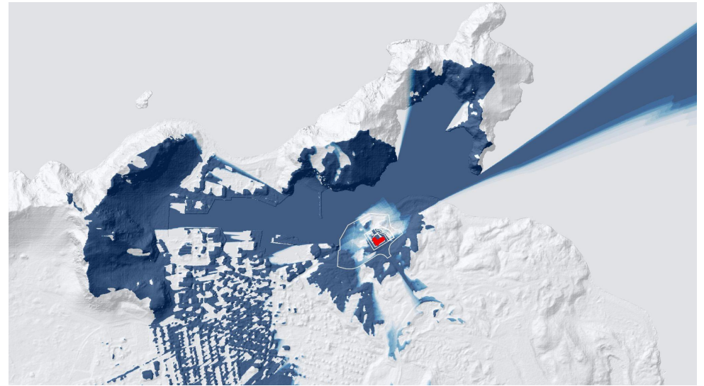
Mynd 4.6: Sýnileikagreining fyrir þjónustubyggingu baðlóns á Skanshöfða. Bláu litirnir sýna frá hvaða stöðum á Heimaey 10 metra hátt mannvirki sést, sem er staðsett þar sem rauðu punktarnir eru. Því dekkri sem blái liturinn er á tilteknum punkti þeim mun meira af mannvirkinu sést frá þeim punkti.
