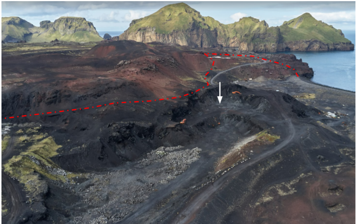
Mynd 4: Mörk E-1 og I-3 (sbr uppdrátt á mynd 7 hér á eftir) sýnd gróflega með rauðri brotalínu. Allt svæðið sjávarmegin við línuna verður lækkað. Hvít ör sýnir hvað viðtakatjörn verður. Myndin er tekin í september 2019.
